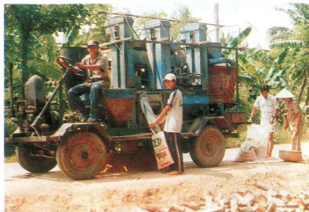
"Nhà máy xay lúa di động" - loại hình tiểu thủ công nghiệp phổ biến ở cù lao Tây
