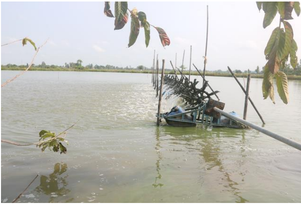
Hệ thống quạt nước giúp tạo dòng chảy và giúp tăng oxy hòa tan cho ao nuôi
